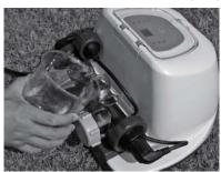
**6.** Dévissez un des bouchons **(9)** de la cellule et videz proprement le vinaigre. Connectez le tuyau qui va de la piscine à la cellule. Rincez le boîtier de la cellule électrolytique avec l'eau de la piscine.
