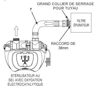
1. Raccordez le tuyau de connexion (7) à la connexion de sortie du filtre de la pompe avec un grand collier de serrage pour tuyau. Serrez fort.
