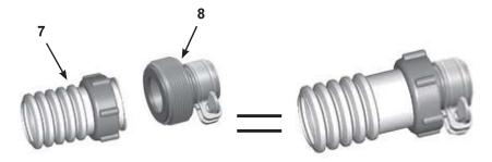
Raccordez l'adaptateur B (8) au tuyau de sortie du filtre épurateur (la sortie basse). Serrez fort
