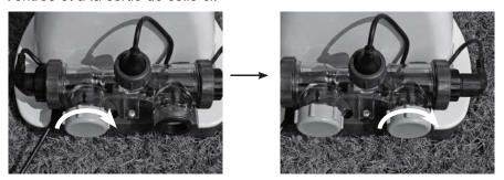
**4.** Dévissez la bague de serrage de la sonde de débit **(6)** et retirez-la du boîtier de la cellule électrolytique **(3)**.
