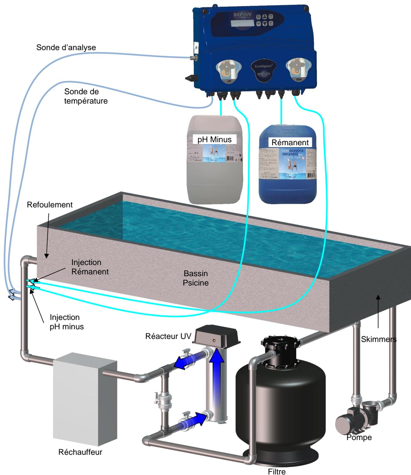
La pression au point d'injection doit être inférieure à 1,5 Bar.
