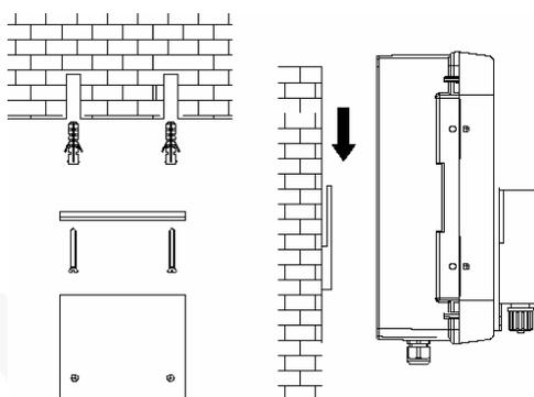
**ATTENTION** : Les vapeurs des produits sont corrosives et peuvent entraîner des dommages de corrosion au nouvel environnement. L'appareil ne doit pas être situé au-dessus du réservoir de produit : prévoir un décalage de 2 mètres
